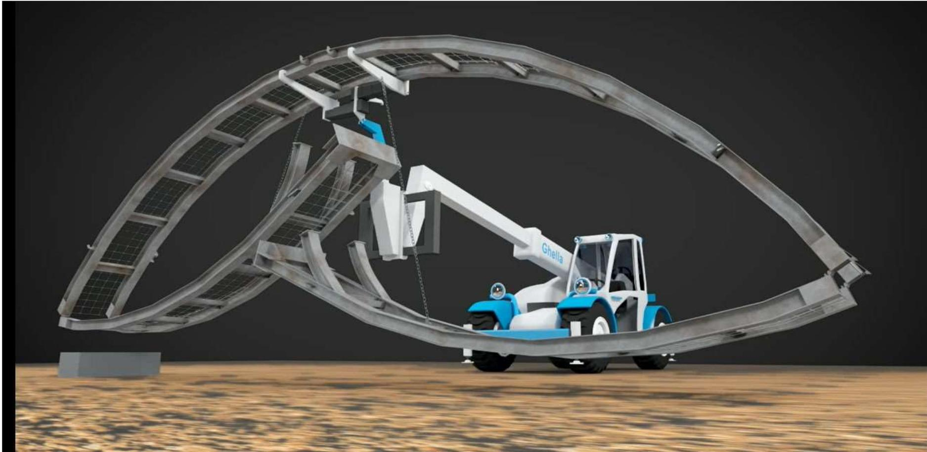
Vengono utilizzate a seconda del produttore centine rigide a profilato oppure a tubo, centine cedevoli T.H.
