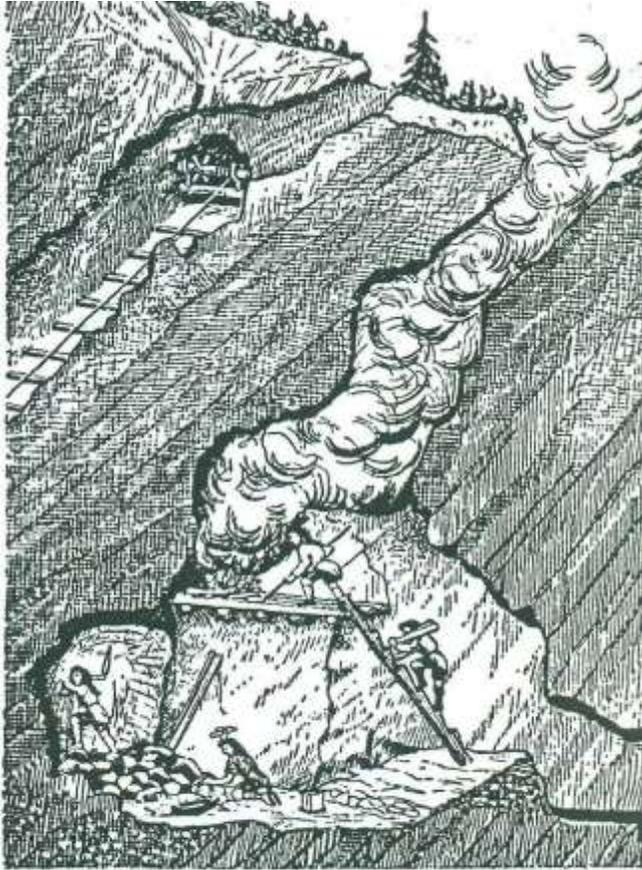
—Ricostruzione di una miniera di rame a Mitterberg nel Tirolo. Il fuoco viene usato per spaccare la superficie della roccia. 1600-800 a.C.
